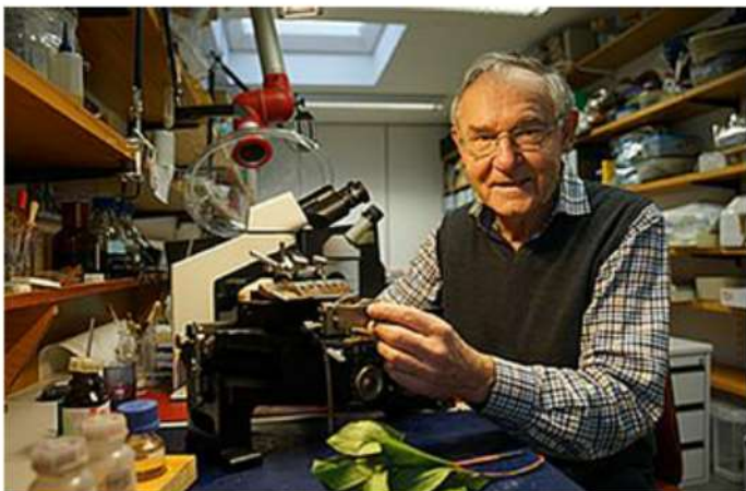
Fritz Schweingruber am selbst entwickelten Schlittenmikrotom, mit dem er zehntausende Dünnschnitte von Pflanzenproben hergestellt hat.
