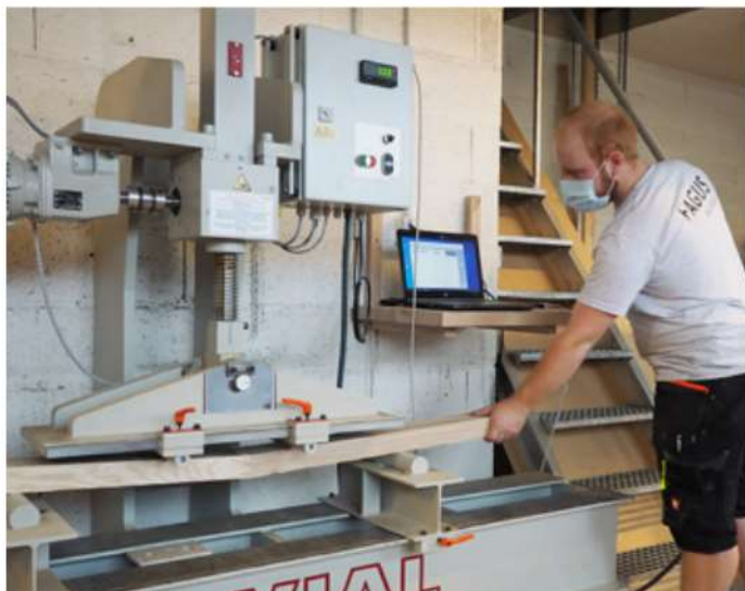
Qualitätskontrolle: Belasten bis das Brett bricht.
